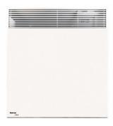
Melodie Evolution — электрический обогреватель конвективного типа. Вся конструкция прибора направлена на равномерное распределение тепла для обогрева с максимальным комфортом. Устройство работает по принципу естественной конвекции. Холодный воздух, проходя через конвектор и его нагревательный элемент, нагревается и выходит сквозь решетки-жалюзи, незамедлительно начиная обогревать помещение.
