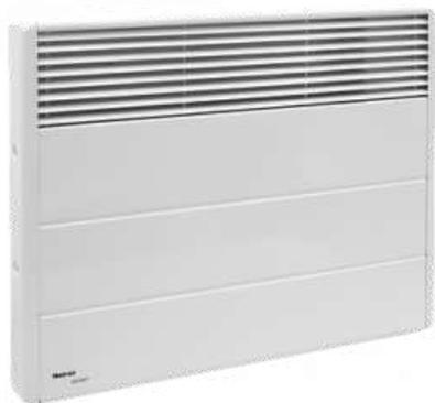
Antichoc — электрический обогреватель конвективного типа (конвектор). Вся конструкция прибора направлена на равномерное распределение тепла для обогрева с максимальным комфортом. Устройство работает по принципу естественной конвекции. Холодный воздух, проходя через конвектор и его нагревательный элемент, нагревается и выходит сквозь решетки-жалюзи, незамедлительно начиная обогревать помещение.
